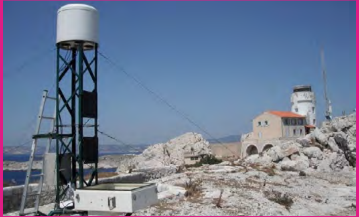
Station du réseau de mesure DEMO pour la quantification des flux massiques de dépôt de poussières désertiques sur le bassin Ouest méditerranéen (Ile du Frioul, France).
